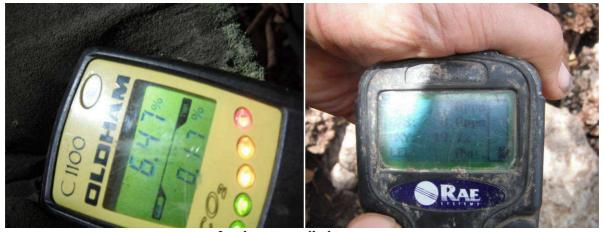
Les deux appareils de mesure : modèle C1100 de la marque OldHam et modèle QRAEII de la marque RAE System
